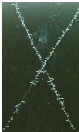
①クロメート (シルミナイズ150P) ディップ処理
