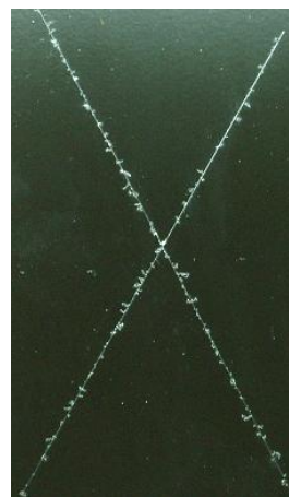
③ノンクロメート (アルフェイスNC01) ディップ処理
