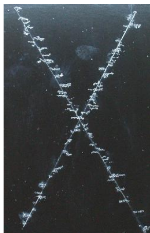
②ノンクロ従来品 (シルミナイズAV12) ディップ処理
