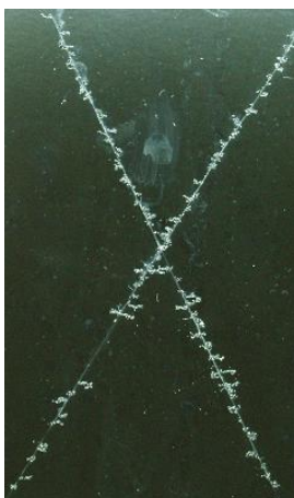
①クロメート (シルミナイズ150P) ディップ処理
